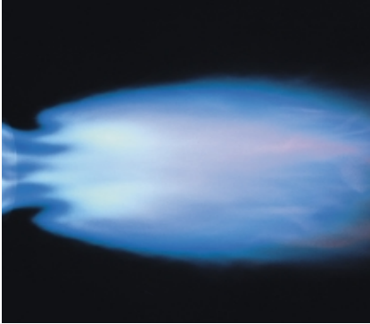
Типичный факел горелки исполнения LowNOx в режиме работы на газе
