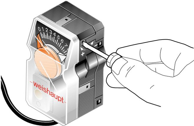
Как правило, после предварительной настройки значения  $\text{CO}_2$  составляют 12-13%. Предварительная настройка не заменяет обязательного измерения дымовых газов и оптимизации сжигания!
