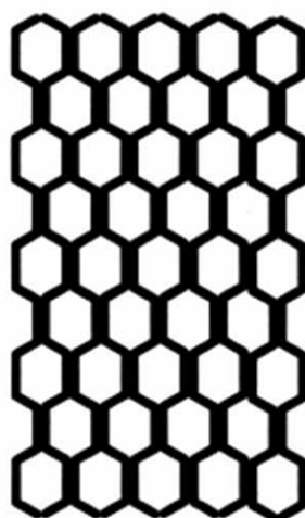
Рисунок В.5 – Вид пакета пластин при правильной сборке
