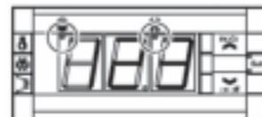
2 Нажатием кнопки Mode в течение 1 секунды, чиллер включается в режиме охлаждения (На дисплее загорается индикатор 5).
