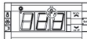
3 Нажатием кнопки Mode в течение 1 секунды, чиллер из режима охлаждения переключается в режим отопления. На дисплее загорается индикатор 4.
